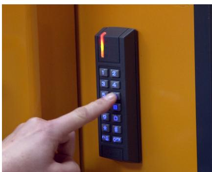
Un verrou automatique digital permet de charger la presse mais limite l'accès à la fonction de compactage.
