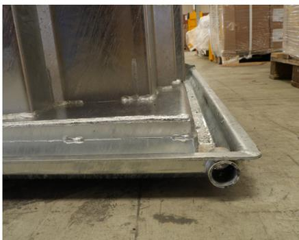
Un système d'écoulement évacue les liquides de votre presse pendant le compactage des déchets humides.
