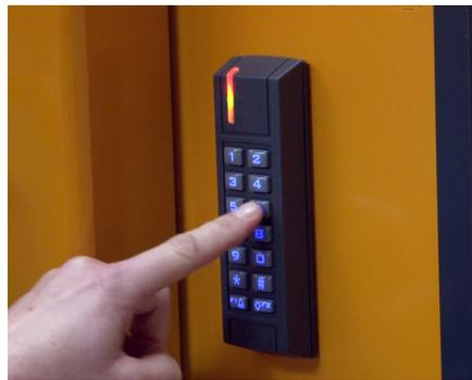
Un bloqueo automático digital permite cargar la prensa, pero restringe el acceso a ejecutar un ciclo de la prensa.
