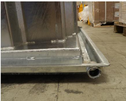
Un sistema de drenaje conduce los líquidos fuera de la prensa durante la compactación de residuos húmedos.
