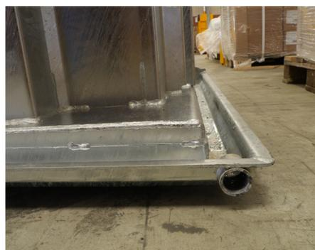
Un sistema de drenaje conduce los líquidos fuera de la prensa durante la compactación de residuos húmedos.
