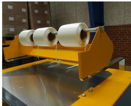
El porta cinta montado en la parte superior le permite instalar su prensa más cerca de la pared.
